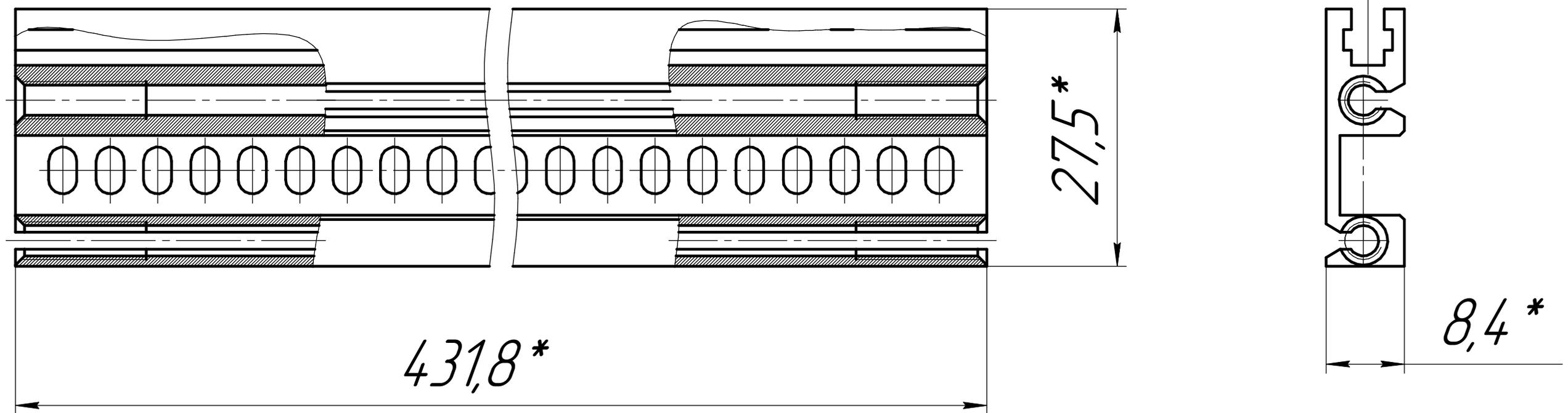
*Рисунок 1. Внешний вид и профиль релинга заднего*
